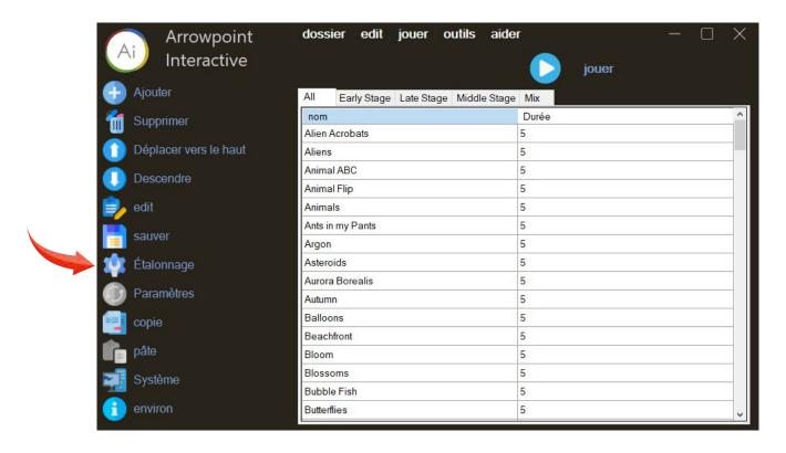
Si l'image projetée n'est pas entièrement contenue dans la fenêtre supérieure gauche, il sera nécessaire de déplacer physiquement la caméra IR pour qu'elle voie l'image projetée sur le sol, le mur ou la table. Si l'image est inversée ou à l'envers, cochez ou décochez les cases Miroir horizontal et Miroir vertical jusqu'à ce qu'elle apparaisse correctement.
