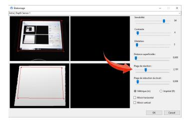
4. Faites glisser l'onglet Surface Distance vers la gauche, l'écran inférieur droit devient noir. Déplacez lentement l'onglet vers la droite, jusqu'à ce que l'écran inférieur droit devienne blanc, puis arrêtez. Si un petit coin reste noir, ce n'est pas grave. L'important est que la zone projetée soit entièrement blanche.
