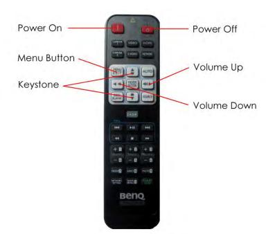
Une fois que le projecteur est allumé à l'aide du bouton Power On et que le système a chauffé, vous pouvez remarquer que la projection n'est pas carrée. Si c'est le cas, il suffit de pointer la télécommande vers l'unité Lucynt et d'appuyer sur les boutons fléchés Keystone vers le haut ou vers le bas pour redresser l'image.
