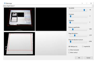
5. Faites glisser l'onglet Gamme de réaction vers la gauche, l'écran inférieur droit devient noir. Déplacez lentement l'onglet vers la droite, jusqu'à ce que l'écran inférieur droit devienne blanc. Si un petit coin reste noir, ce n'est pas grave. L'important est que la zone projetée soit entièrement blanche.
